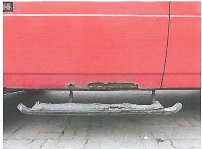
Uszkodzony próg pojazdu
