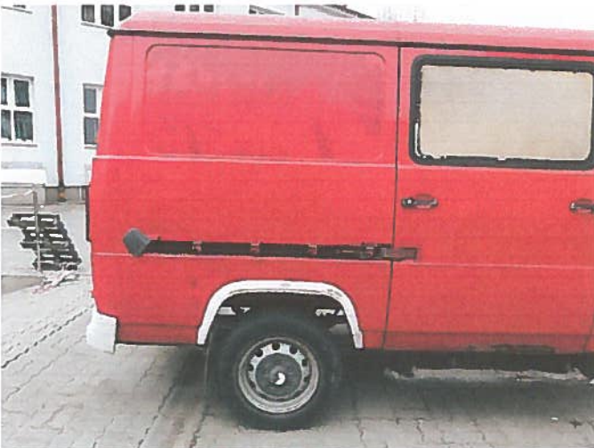
Uszkodzona listwa drzwi prawych
